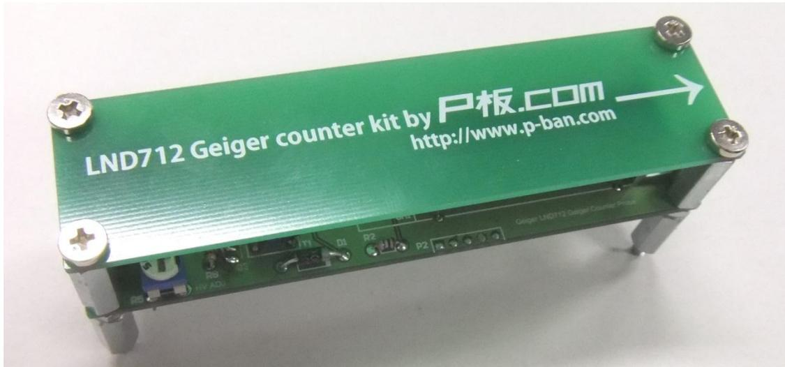
最後に表示部に載せナットで固定してください。なお、プローブ部を独立して使用する場合はナットでの固定は不要です。以上で組み立てと調整は終了となります。
